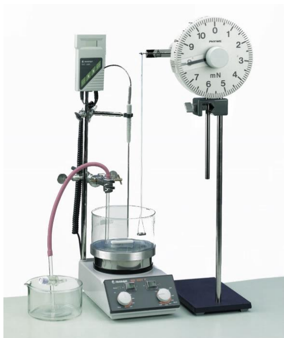
Rys. 2. Układ pomiarowy do pomiaru napięcia powierzchniowego metodą pierścieniową z dynamometrem obrotowym i mieszadłem magnetycznym.
