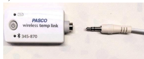
Rys. 3. Elementy składowe układu: a) sonda ciśnienia z silikonową rurką, b) sonda temperatury z przewodem typu Jack.
