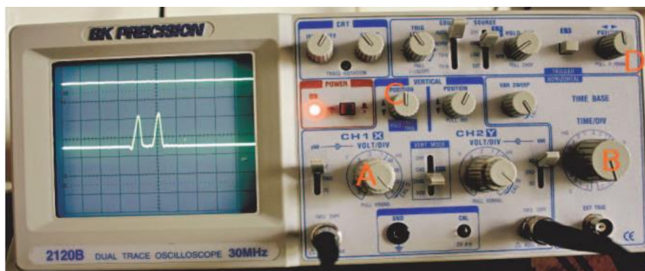
Rys. 2. Panel oscyloskopu 2110B; A – pokrętło czułości toru pomiarowego, B – pokrętło podstawy czasu, C – pokrętło przesuwu w pionie przebiegu dla kanału A, D – pokrętło przesuwu w poziomie przebiegu dla kanału A.
