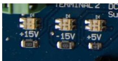
Rysunek 5. Diody sygnalizacji obecności zasilania na płycie prototypowania: +15V; -15V; +5V.
